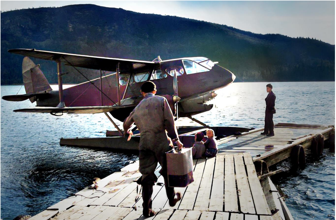
1956 DeHavilland DH 89 Dragon Rapide SE-BTA tankar vid bryggan i Laisvall. Flygplanet tillverkades 1941 och ägdes 1953-59 av Boliden. Den tog 6-10 passagerare och drevs av 2x139 hk som gav en maxfart 206 km/tim (Skellefteå museum, färglagd)
