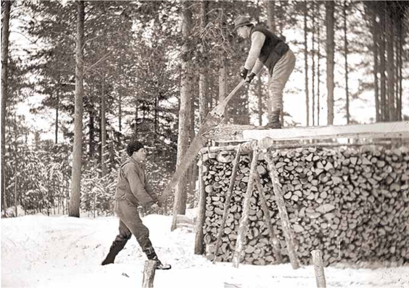
1925 Kransågning med hemmansägare Anders Antonsson. Personen nere på marken drar ned sågen och den två meter upp på stocken drar upp den. Sågbladet är 160 cm och med handtaget över 2 m långt (källa Skellefteå museum).
