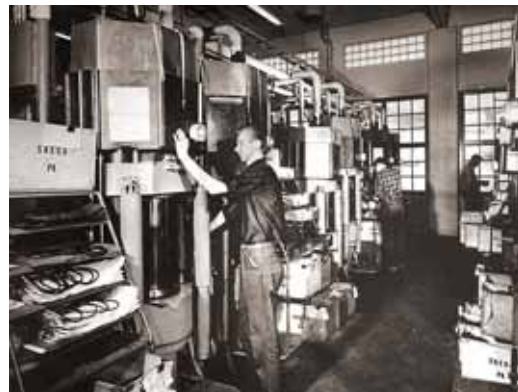
Pressning av O-ringar (foto Okänd).
