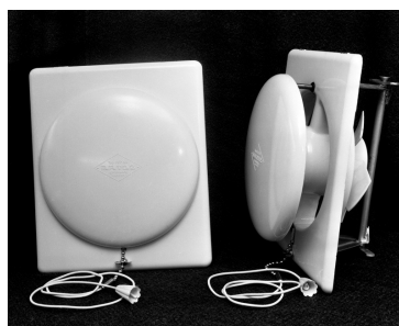
Bild 25: Fläkten Matoz. Den var avsedd att monteras i den ventil med självdrag som normalt fanns på väggen eller muren nära taket över köksspis. Drog man i snöret startade fläkten då den tillsammans med kåpan åkte ut ett stycke.
