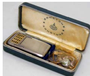
Sonophone 1010 blev den första hörapparaten med transistorteknik när den kom 1952
